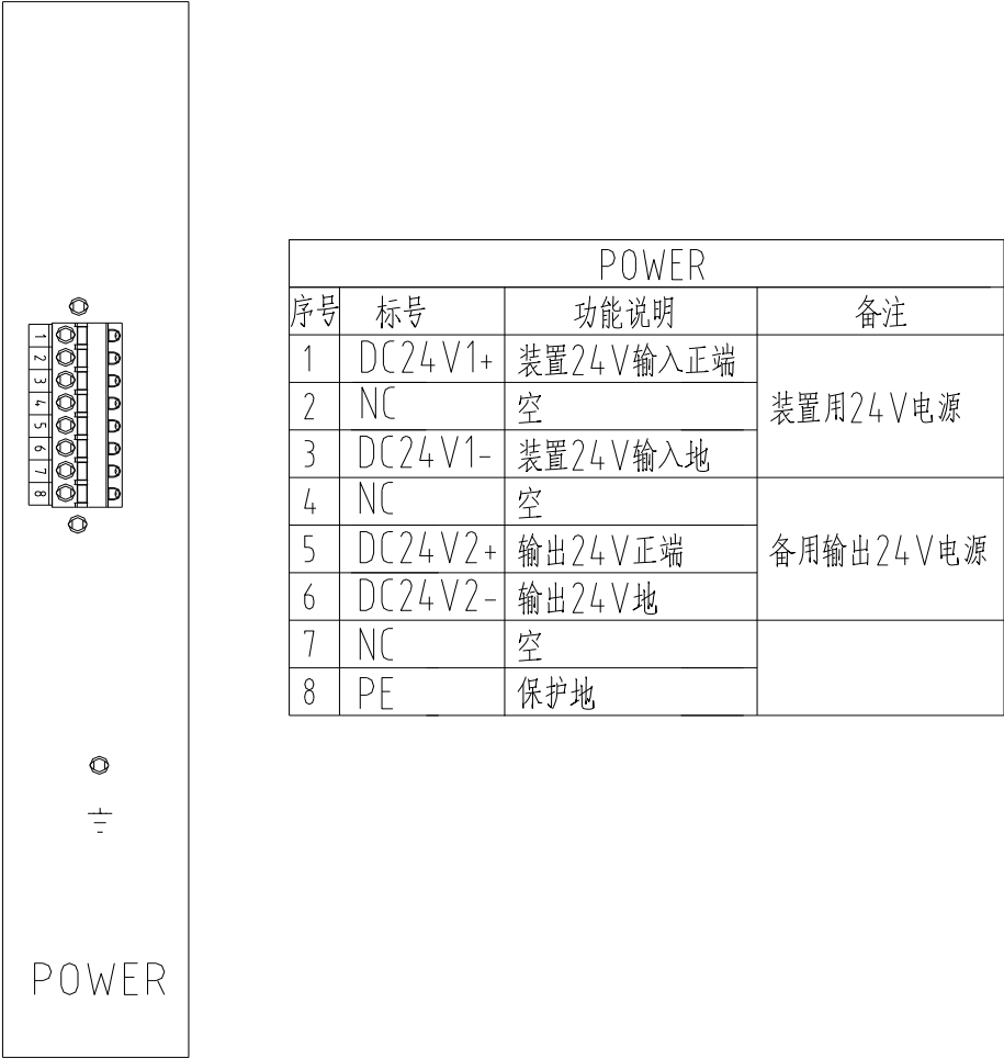
图 5-2 电源插件及端子定义
